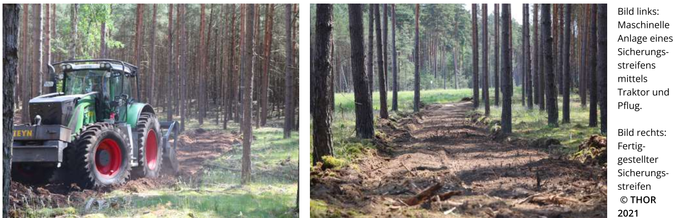
Abbildung 10: Mögliche Bodenbearbeitung zur Anlage von Sicherungstreifen mittels maschineller Umsetzung durch Traktor.
