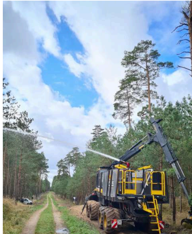
Abbildung 18: Beispielhafte Vorführung eines Löschwassersystems für Forstmaschinen, Muster des Wasserwerfers zur Bewässerung von Randbereichen entlang der Waldwege auf Nebel eingestellt – Darstellung mit technischen Daten.
