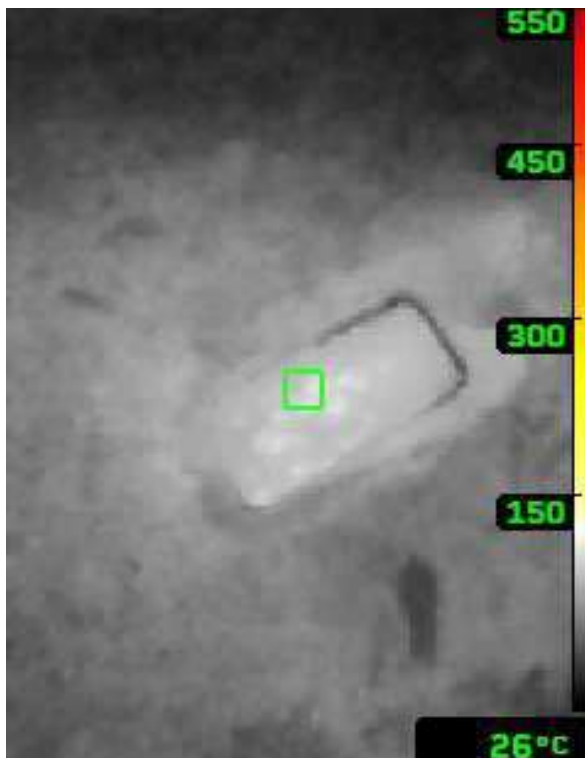
Abbildung 27: Künstlich angelegte Glutnester zur Erkennung der thermalen Strahlung für die Aufnahme mittels tragbarer Wärmebildkamera
