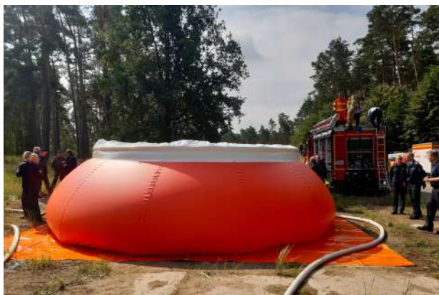
Abbildung 21: Erprobung eines Waldbrandbehälters mit einem Fassungsvermögen von 55.000 Litern – Darstellung mit technischen Daten © THOR 2024
