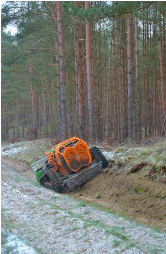
Abbildung 12: Mögliche Bodenbearbeitung zur Anlage von Sicherungstreifen mittels maschineller Umsetzung durch Raupe.
