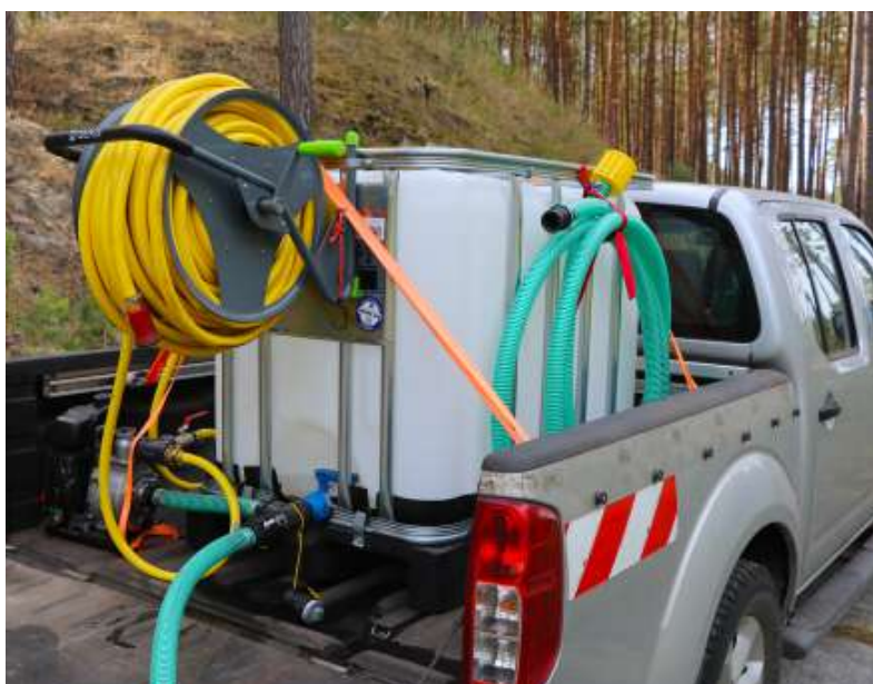
Abbildung 20: Für Erprobungszwecke angefertigtes selfmade Pickup-Löschmodul für das Waldbrandschutzprojekt THOR-Darstellung mit technischen Daten und Materialliste
