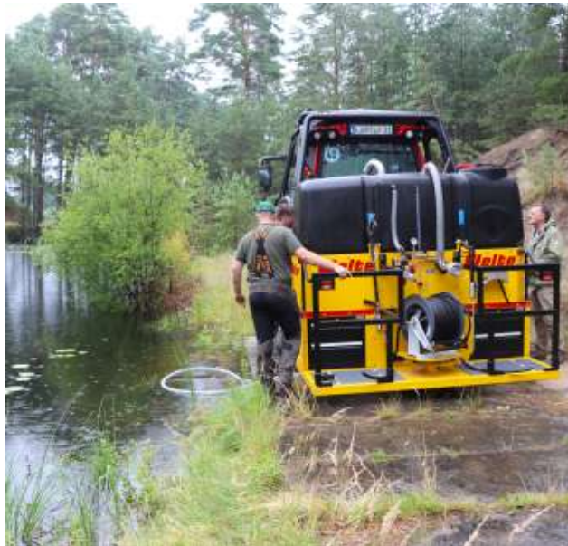
Abbildung 19: Beispielhafte Inbetriebnahme eines Tankrucksacks im Forstamt Kaliß durch das Projekt THOR, Ausführung mit 1.600 Litern Fassungsvermögen und Materialstauflächen mit Stehpodest für zwei Personen – Darstellung mit technischen Daten.
