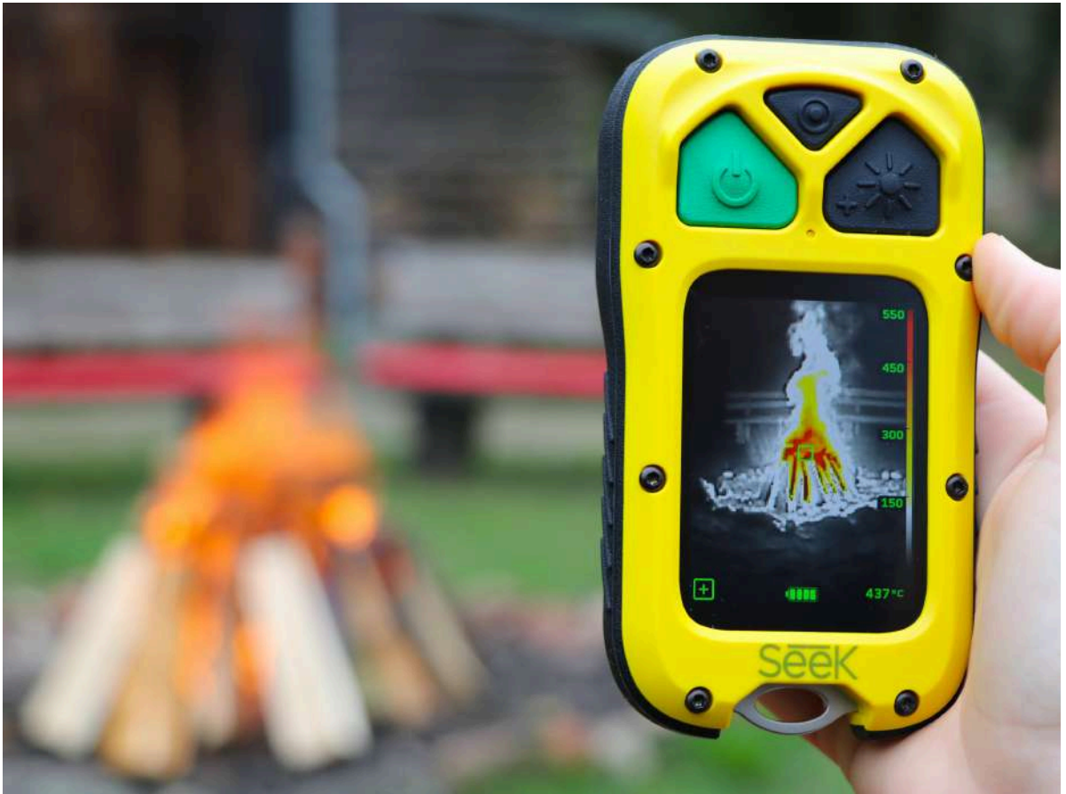
Abbildung 26: Einsatz einer tragbaren Wärmebildkamera am offenen Feuer.
