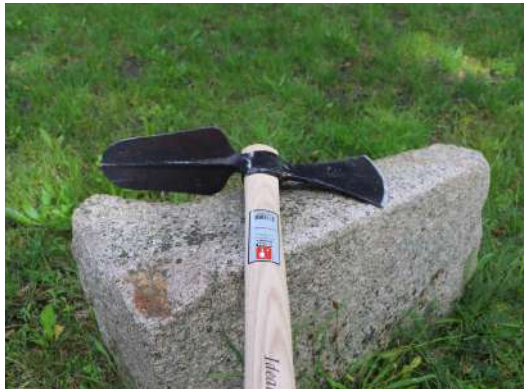
Abbildung 25: Geeignete Werkzeugkombination zur Einwirkung auf Glutreste – Wiedehopfhacke mit Ovalblatt und flexibler Löschrucksack
